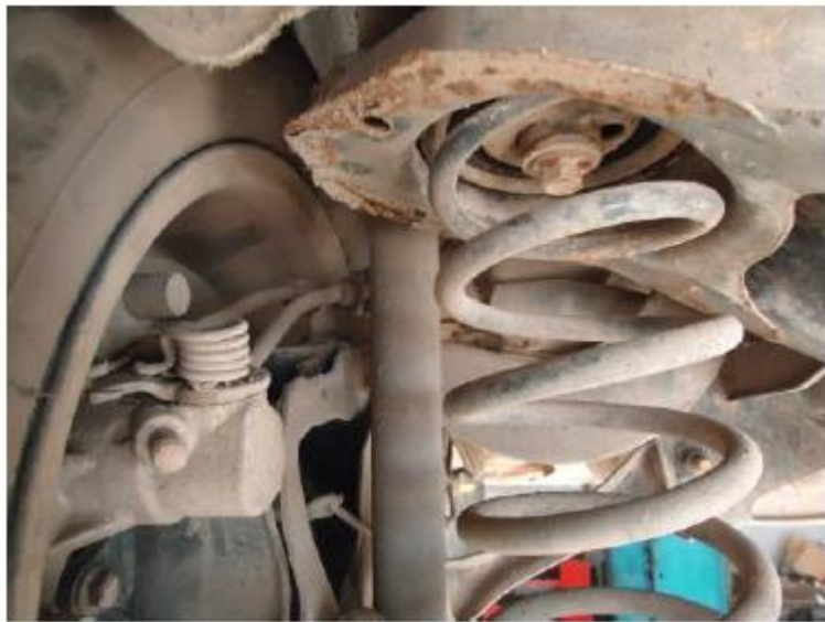
减震弹簧装配处腐蚀
