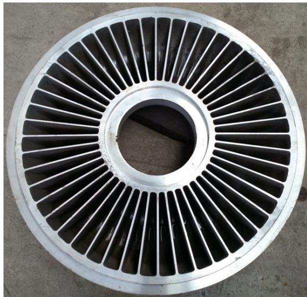
直径1200mm 铝合金铸件(ZL201) 砂型铸造
