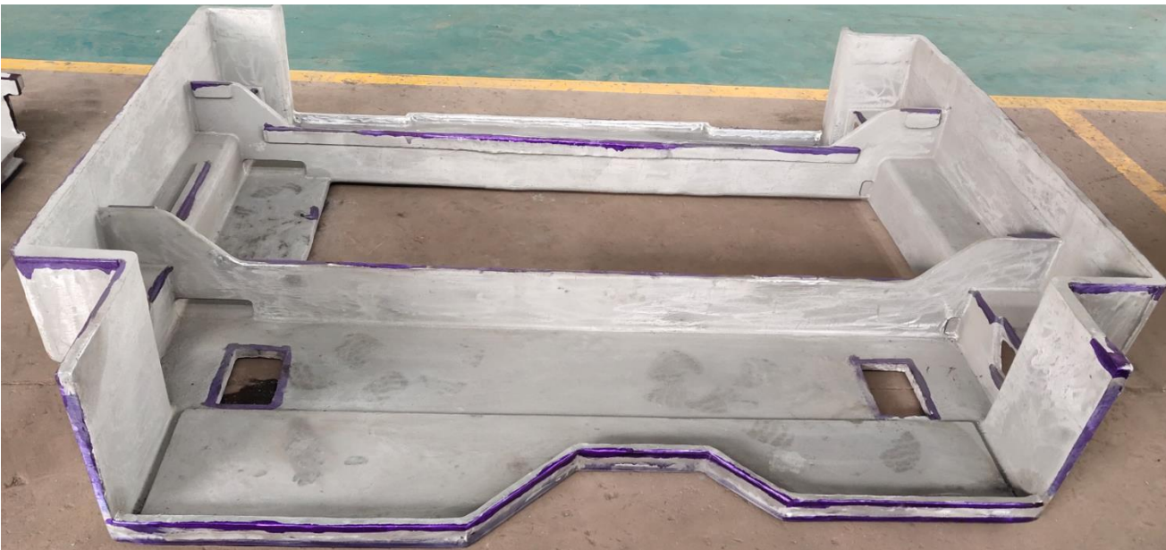
长2000mm, 宽1700mm, 高450mm 铝合金底部框架(ZL101A)
