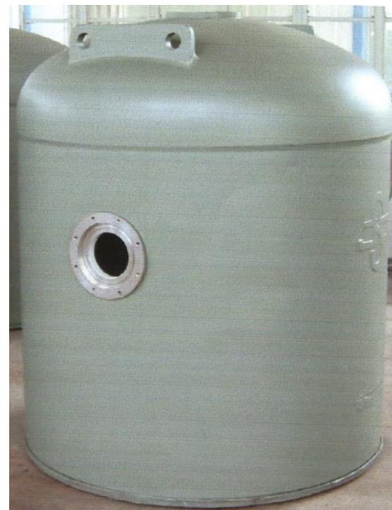
直径1100mm, 高1200mm 铝合金壳体(ZL101A) 砂型铸造
