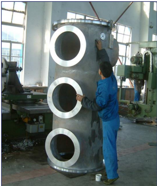
高1900mm 铝合金壳体(ZL101A) 砂型铸造
