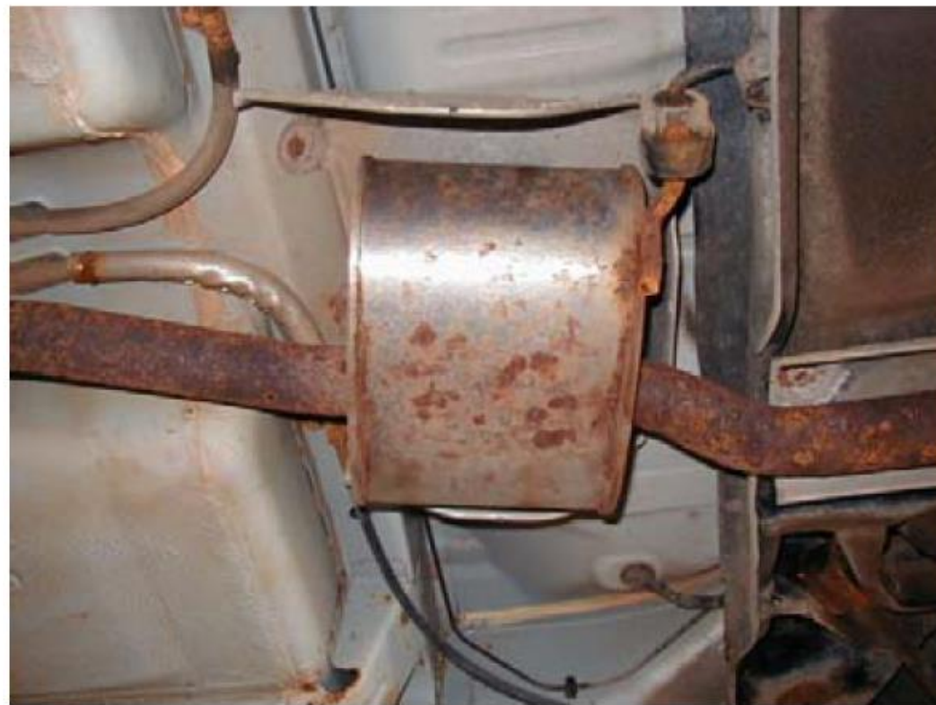
不锈钢中消声器轻度腐蚀
