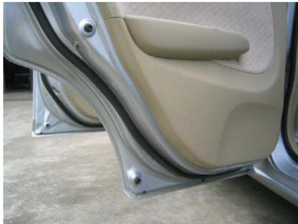
车门折边处有折边胶未出现腐蚀
