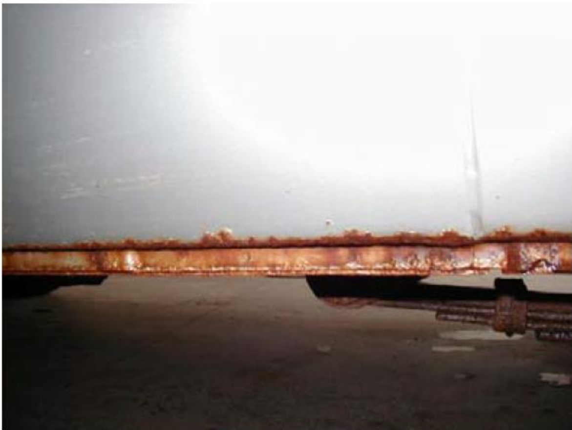
车身下裙板没有防护出现腐蚀
