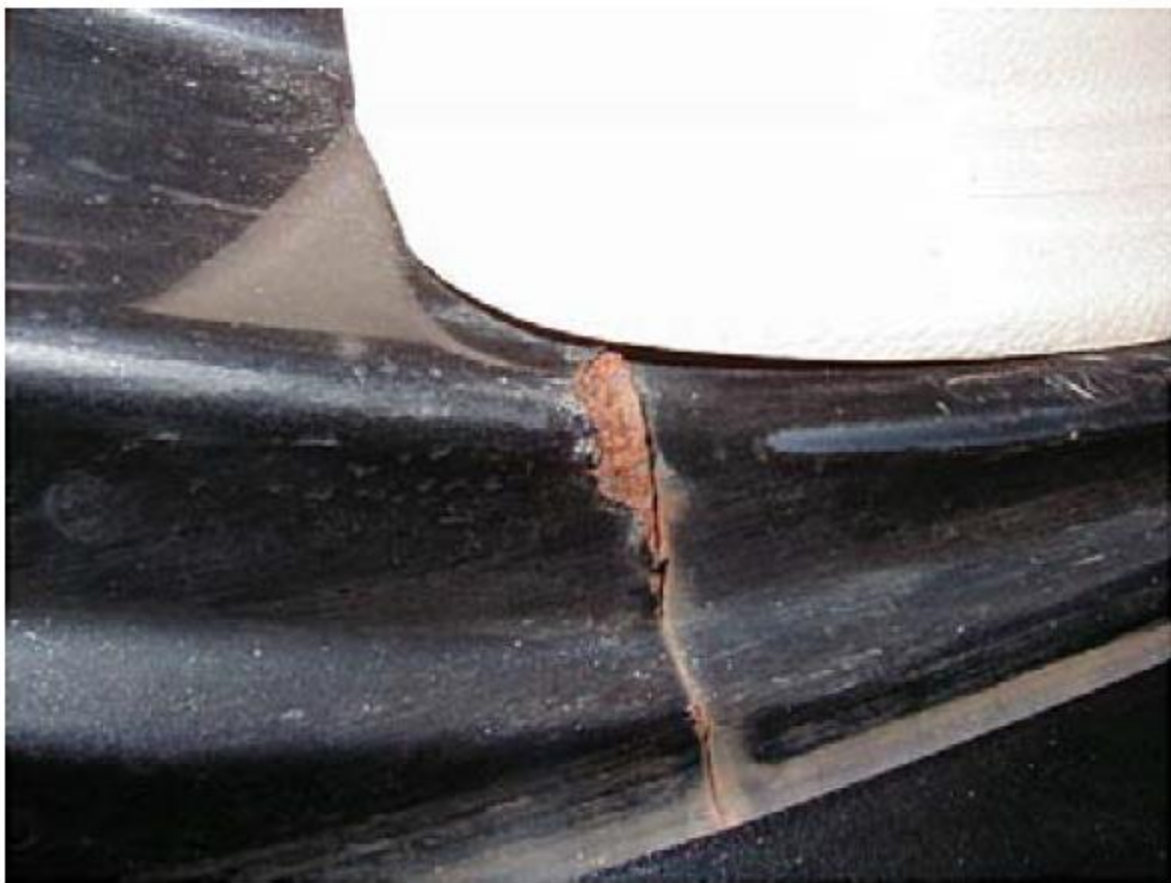
车门坎有接缝容易发生腐蚀
