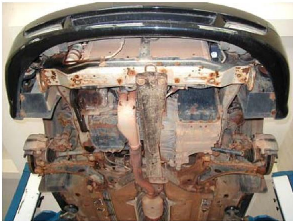
发动机仓下部无防护，腐蚀严重
