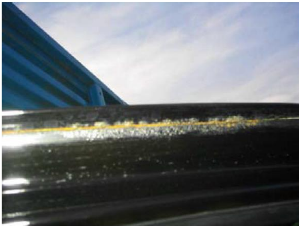
车门折边处没有折边胶起泡生锈
